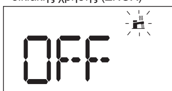
Εικ. 12 Απενεργοποίηση λειτουργίας νερού οικιακής χρήσης (ZNOX)
