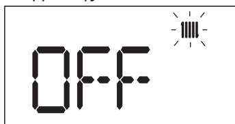
Εικ. 11 Απενεργοποίηση λειτουργίας θέρμανσης
